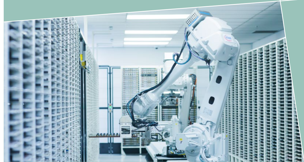
Einsatz von Robotern beim Ein- und Auslagern der schweren und fragilen Burn-in-Boards.
