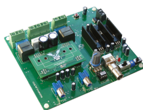
IRAUDAMP16 音频 通道数量:2 每个通道输出功率 [RMS]:70 W 特色D类IC:IR4302M 输入:模拟 OPN: IRAUDAMP16
