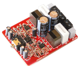
IRAUDAMP15 音频 通道数量:2 每个通道输出功率 [RMS]:35 W 特色D类IC:IR4311M 输入:模拟 OPN: IRAUDAMP15
