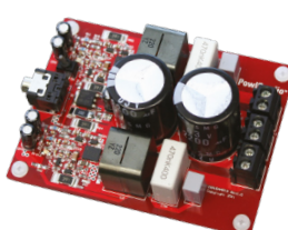
IRAUDAMP19 音频 通道数量:2 每个通道输出功率 [RMS]:100 W 特色D类IC:IR4301M 输入:模拟 OPN: IRAUDAMP19
