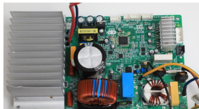
小体积单电解双直流变频驱动板 佛山市顺德区而而泰电子科技有限公司
